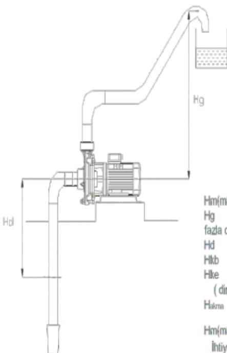
$H_m(mSS)$  :Toplam manometrik yükseklik (mSS)
